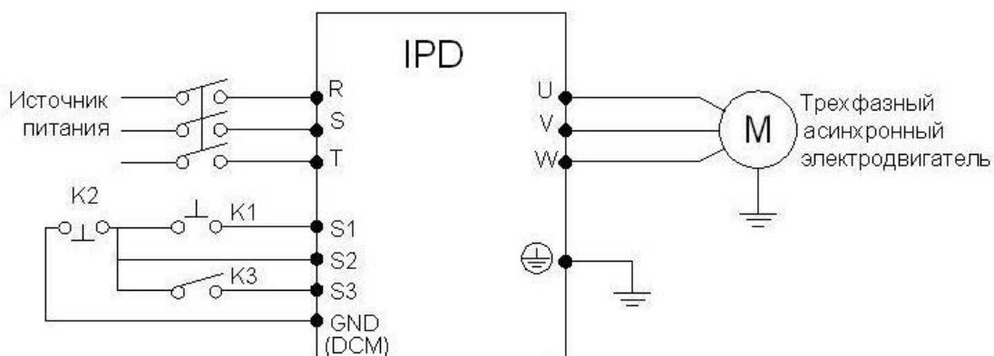
(2) Настройка параметра PF33 определяющего направления вращения
