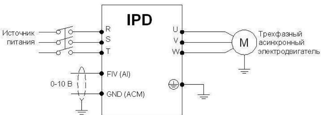
Аналоговое напряжение 0-10В можно сформировать внешним потенциометром 10 кОм. Изменение частоты происходит при изменении напряжения от 0 до 10 В между клеммами FIV/AI и GND/ACM
