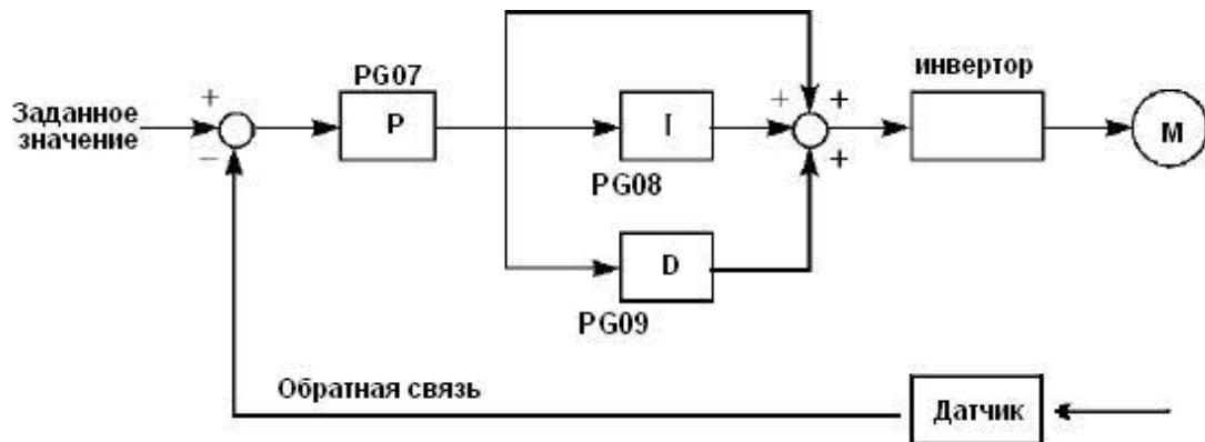
Замечания по использованию преобразователя в режиме PID-регулирования:
