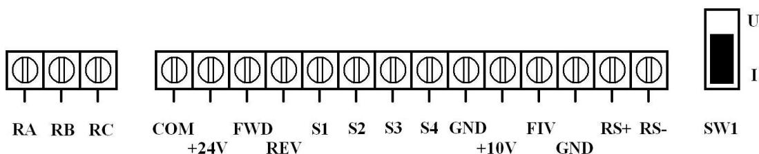
Момент затяжки винтов на клеммах RA, RB, RC, MA, MB - 0.4 Нм.
