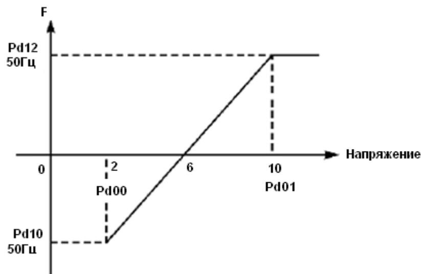
Примечание: Pd00=2, минимальное входное напряжение на входе FIV: 2 В (сигнал с напряжением ниже 2 В считается равным нулю);
