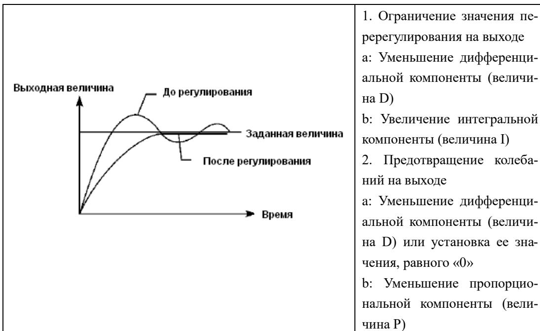
При использовании PI или PID – законов регулирования возможна установившаяся ошибка регулирования с величиной до  $\pm 10\%$  от значения максимального сигнала обратной связи. Допустимая ошибка определяется величиной параметра PG20.
