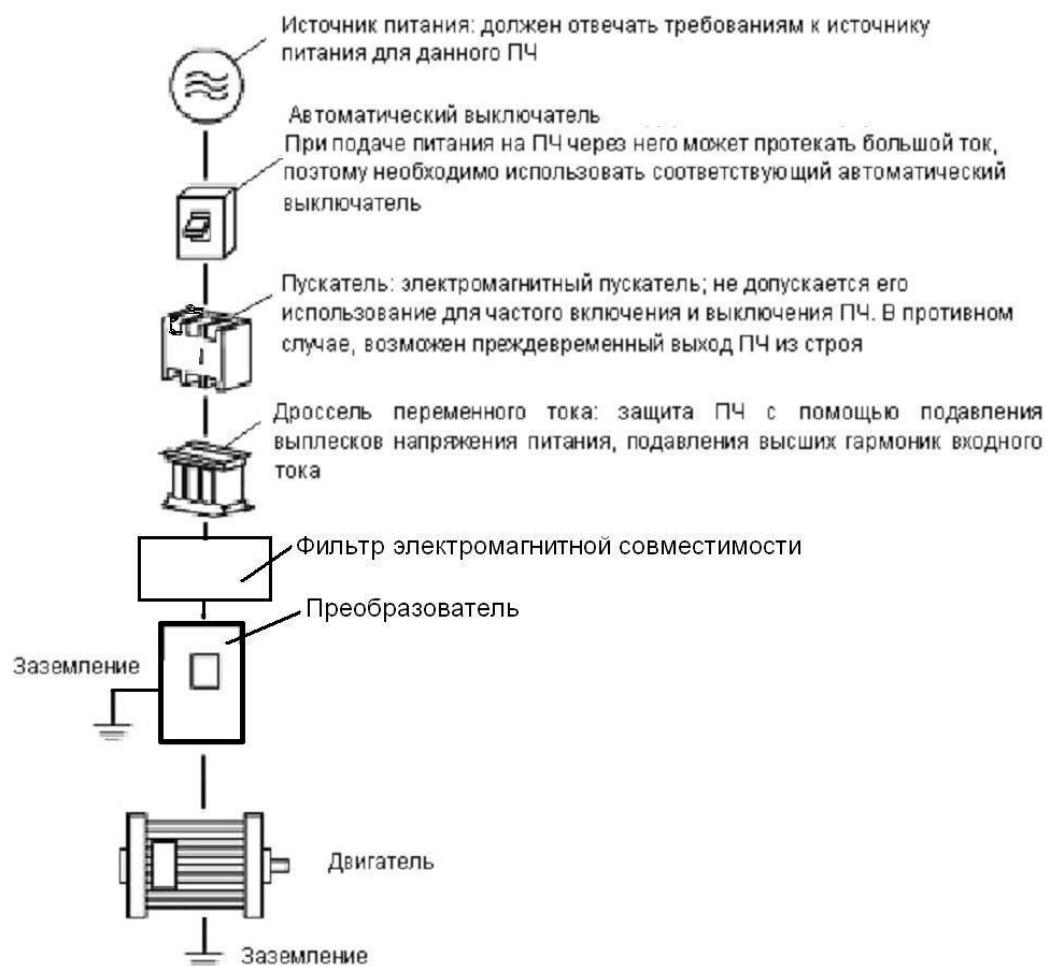
**⚠ ЗАПРЕЩАЕТСЯ подключение проводов питания преобразователя к клеммам U, V и W.**
