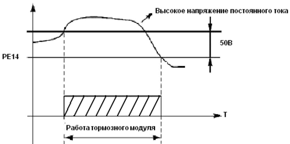
Следует уделить особое внимание настройке этого параметра. Слишком высокое напряжение может вызвать срабатывание защиты ПЧ от перенапряжения; при слишком низком заданном значении тормозной резистор будет перегреваться.
