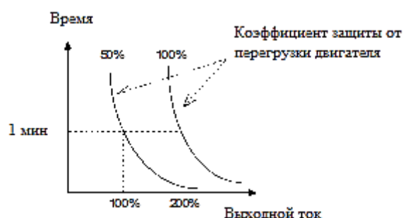
Рис. 6-27 Кривая защиты двигателя от перегрузки
