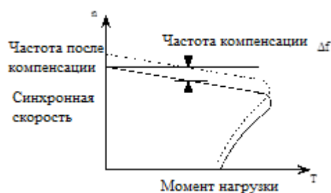
Рис. 6-11 Автоматическая компенсация скольжения
