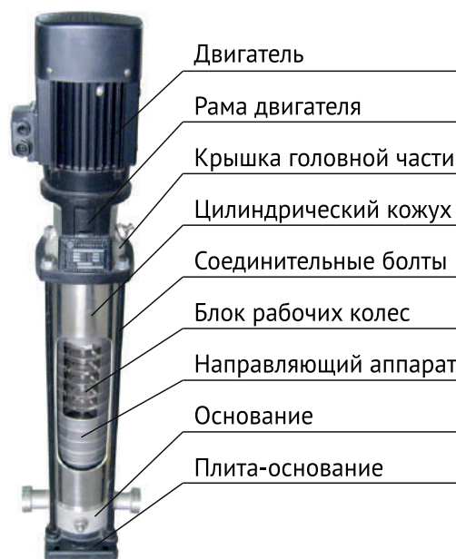
Рис.2. Конструкция насосов
