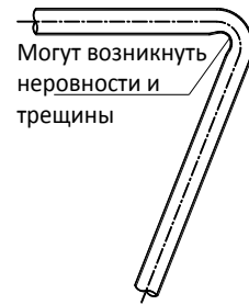
Рисунок 3-5.3: Угол изгиба превышает 90°
