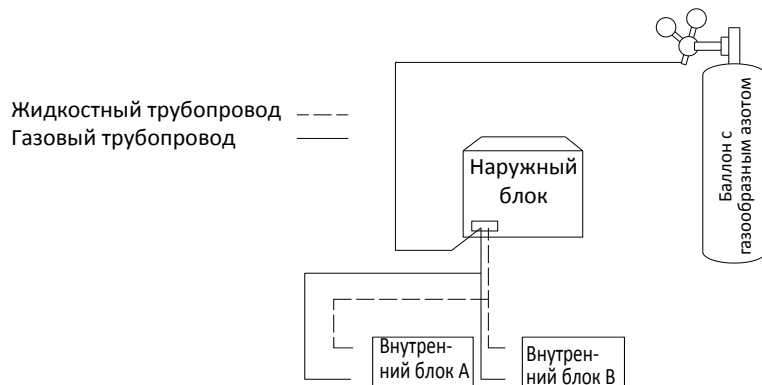
Рисунок 3-5.9: Очистка трубопровода с использованием азота
