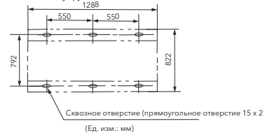
Расстояние между фундаментными болтами показано на Рис. ниже
