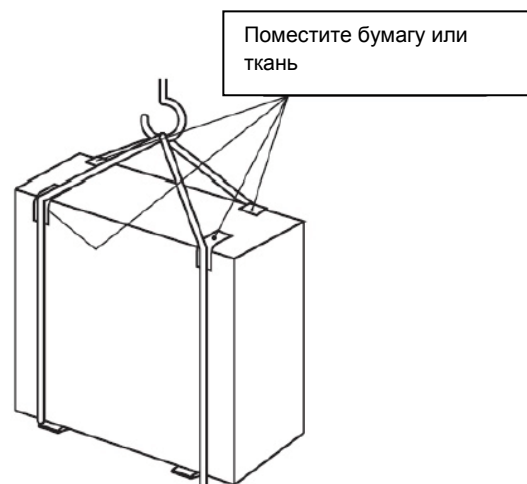
Рис. 3.2 Транспортировка без деревянного основания
