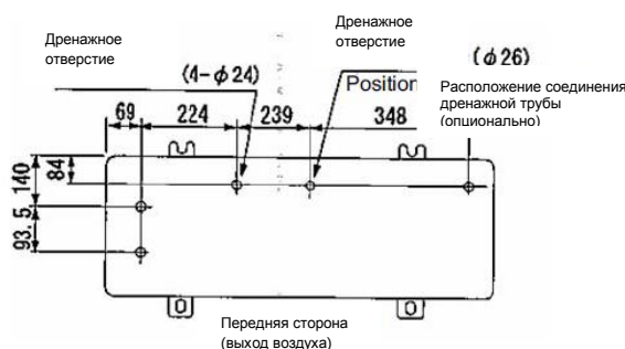
Рис. 4.6 Монтаж рамы и основания
