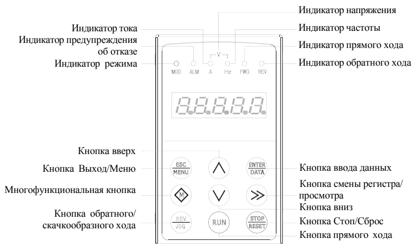
Рис. 5-2 Схема пульта управления
