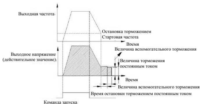
Рис. 7-5 Остановка с замедлением + Торможение постоянным током
