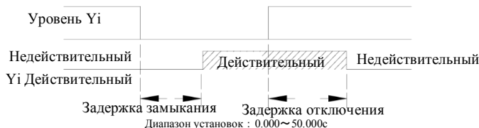
Рис.7-30 Схема работы multifunctional выходного терминала
