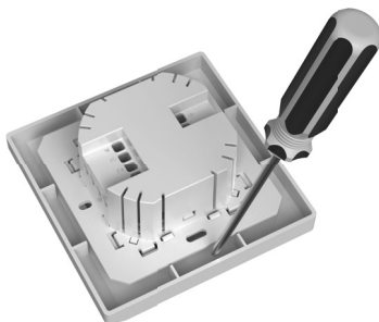
Рис. 5. Демонтаж лицевой панели
