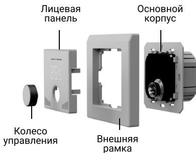
Рис. 3. Устройство терморегулятора
