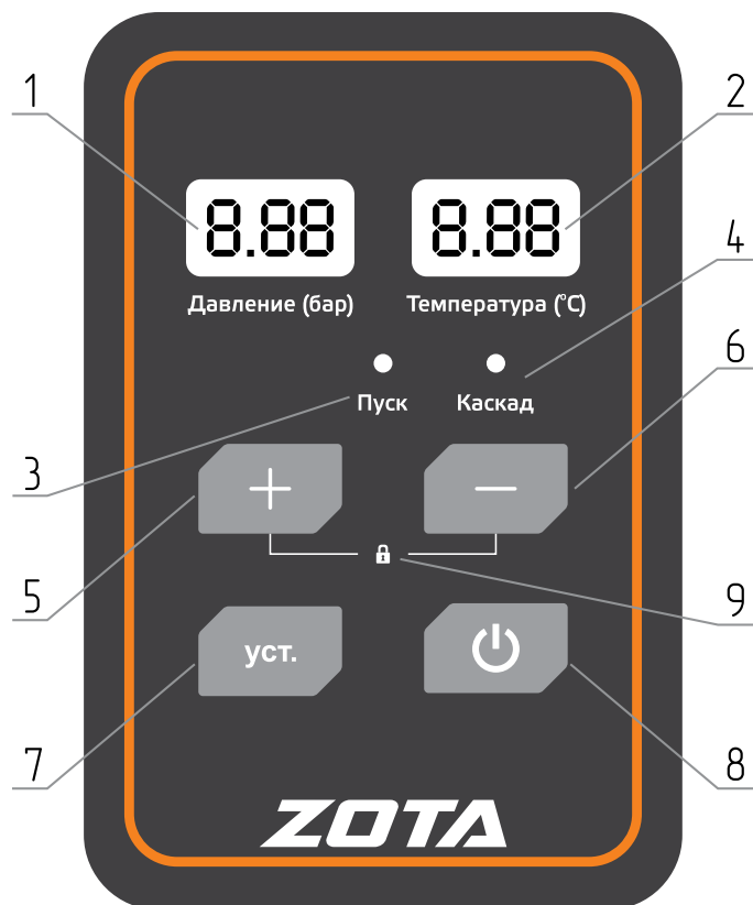
Рис.3 Дисплей панели управления насосной станции ZOTA LaScala
