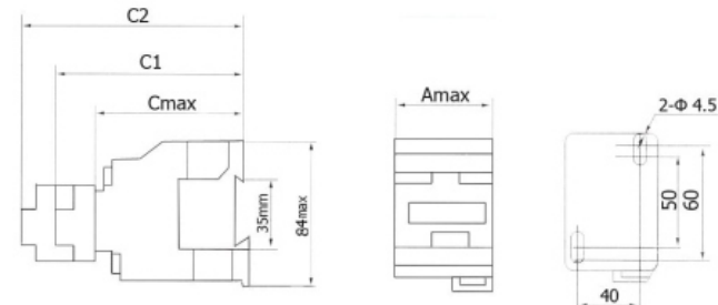
Рисунок 1 – Габаритные и присоединительные размеры пускателей 9 -12А
