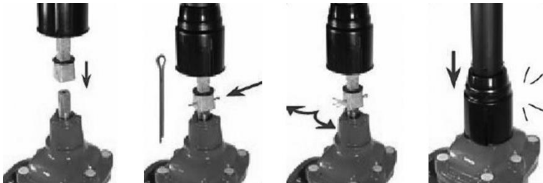
Рис. 4 Порядок установки телескопического штока на задвижку.
