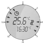
Малюнок 13. Приклад індикації таймера, запрограмованого на 24 години
