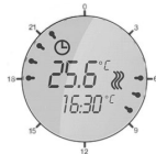
Рисунок 13. Пример индикации таймера, запрограммированного на 24 часа
