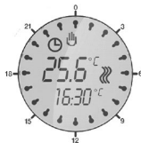
Малюнок 14. Індикація ручного режиму в режимі програмування
