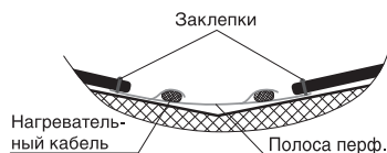
Размещение кабеля в ендове без накладки
