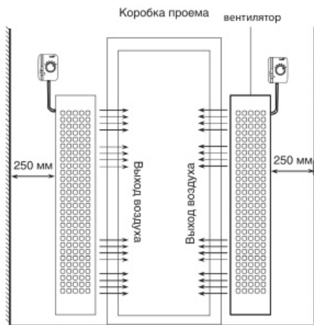
Монтаж выполнен вертикально, сбоку от проема
