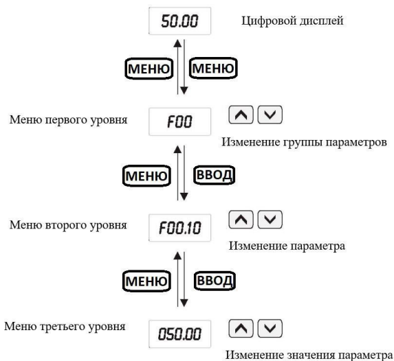
Рис. 6.1 - Схема настройки параметров меню
