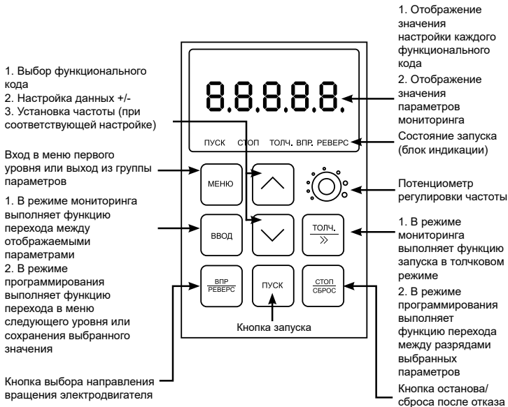
Рисунок 5 – Описание панели управления LCI-KP-S
