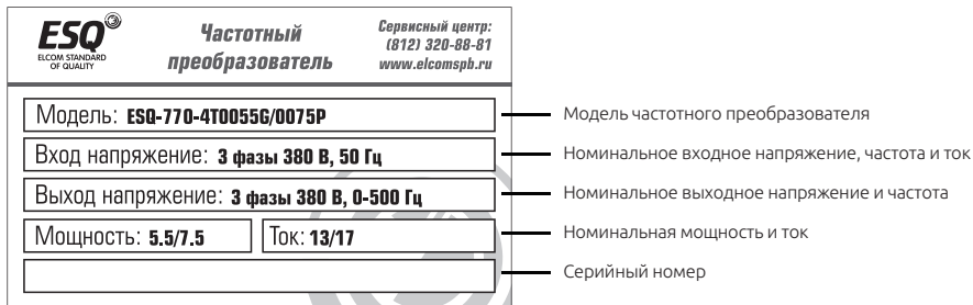
Рисунок 2-4. Изображение шильды частотного преобразователя ESQ-770
