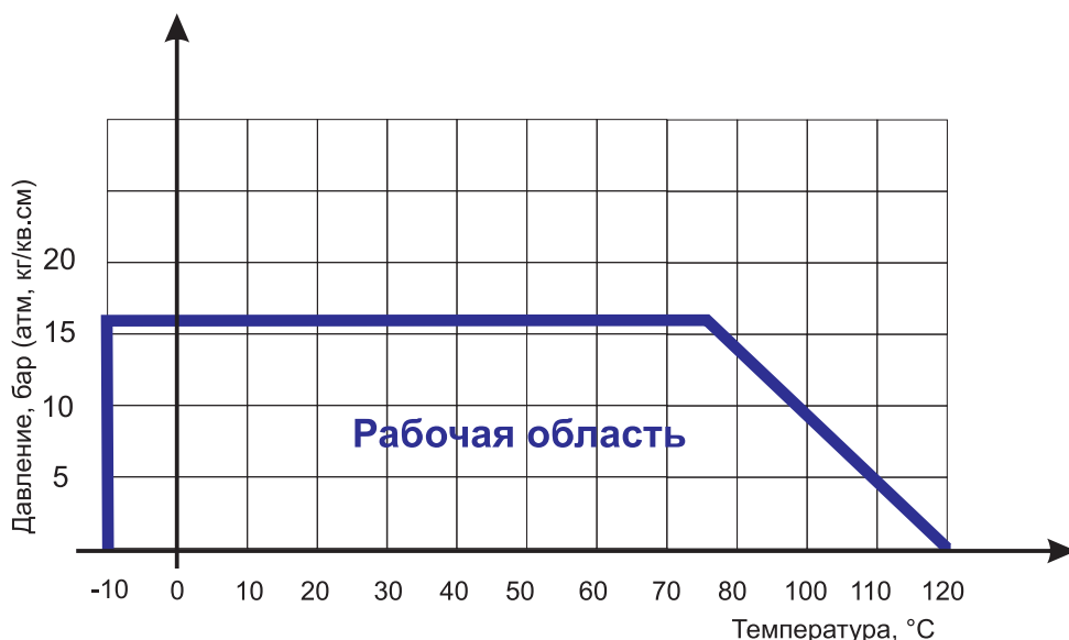
Диаграмма Давление / Температура для задвижки клиновой ABRA-A40-16G с обрезиненным клином и невыдвижным штоком DN 40-600 PN 16:
