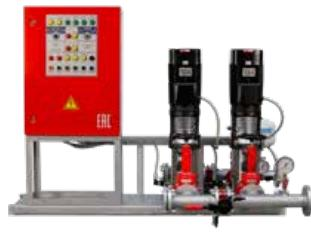
**Область применения:** спринклерные и дренчерные системы пожаротушения, системы с гидрантами, специсполнения для совмещенных хозяйственных и пожарных систем.
