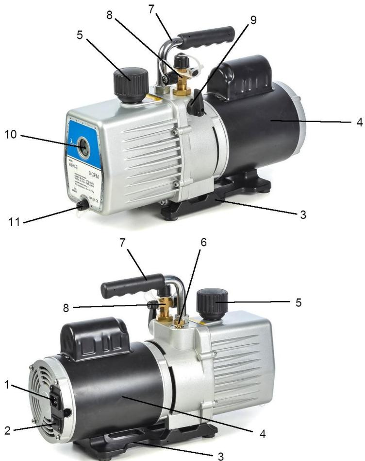
*Внешний вид насоса AHV/ARI: 1 — разъем сетевого кабеля; 2 — выключатель; 3 — опорная рама; 4 — двигатель; 5 — крышка выходного патрубка совмещенная с отверстием для залива масла; 6 — винт газобалластного клапана\*; 7 — ручка для переноса насоса; 8 — выходные фитинги; 9 — обратный клапан; 10 — смотровое окошко уровня масла; 11 — пробка слива масла.*
