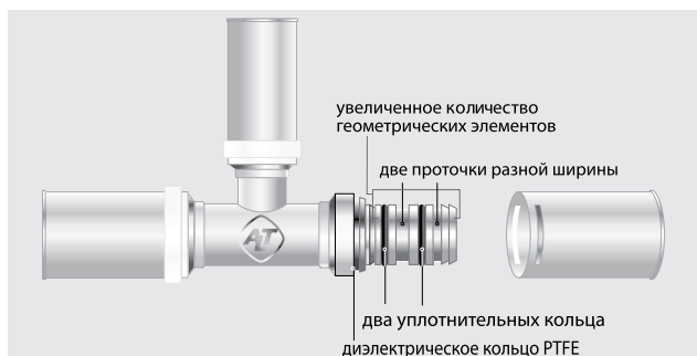
Рис.1. Конструктивные элементы пресс-фитинга.
