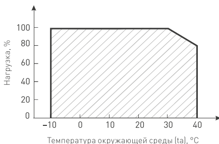
Рис. 2. Максимальная допустимая нагрузка, % от мощности источника
