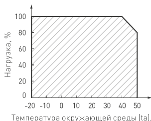
Рис. 2. Максимальная допустимая нагрузка, % от мощности источника
