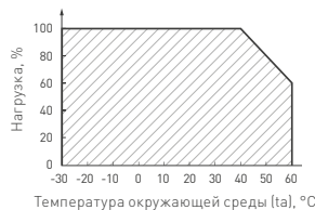
Рисунок 7. Максимальная допустимая нагрузка, % от мощности источника
