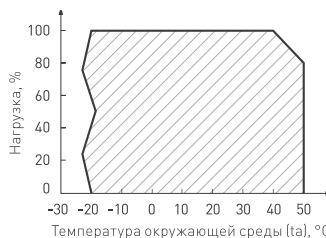
Рис. 3. Максимальная допустимая нагрузка, % от мощности источника
