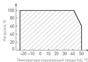
Рис. 2. Максимальная допустимая нагрузка, % от мощности источника
