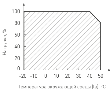
Рис. 2. Максимальная допустимая нагрузка, % от мощности источника
