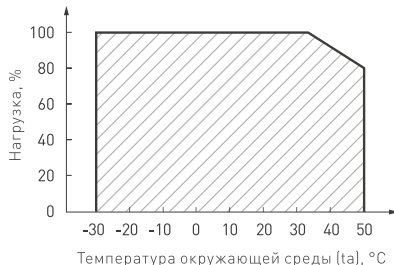
Рис. 2. Максимальная допустимая нагрузка, % от мощности источника
