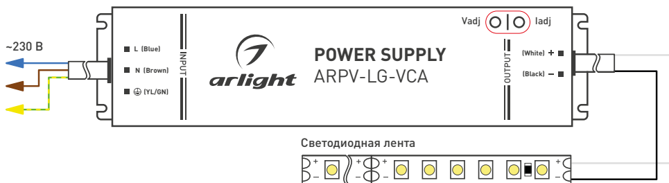
Рис. 1. Пример подключения источника питания
