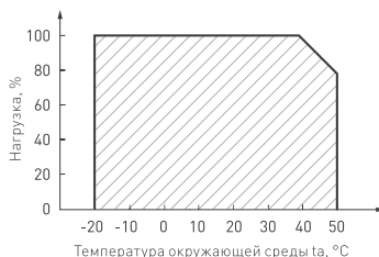
Рисунок 2. Максимальная допустимая нагрузка, % от мощности источника
