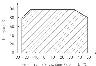
Рис. 2. Максимальная допустимая нагрузка, % от мощности источника
