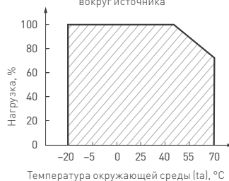
Рис. 4. Максимальная допустимая нагрузка, % от мощности источника
