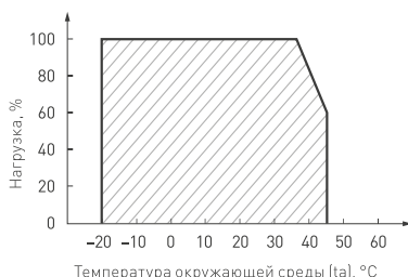
Рис. 2. Максимальная допустимая нагрузка, % от мощности источника
