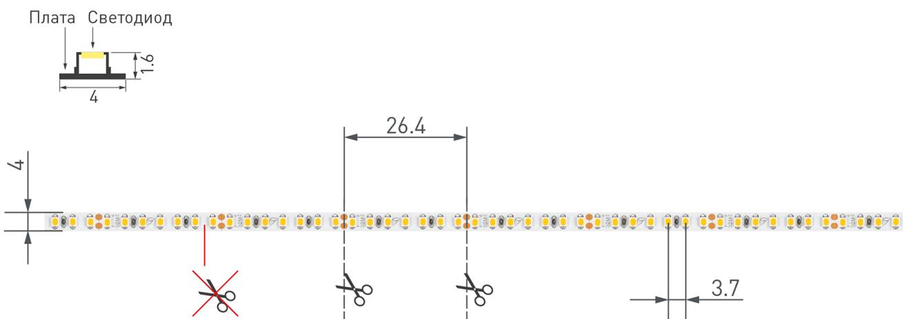
Не допускается разрезать ленту в необозначенном месте.
