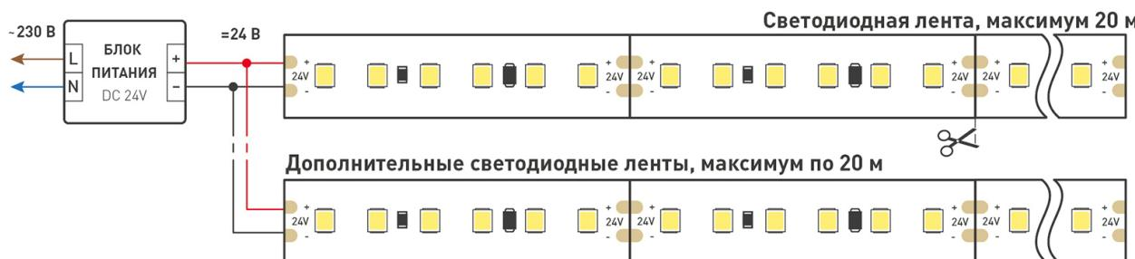
Схема подключения нескольких светодиодных лент с одной стороны.
