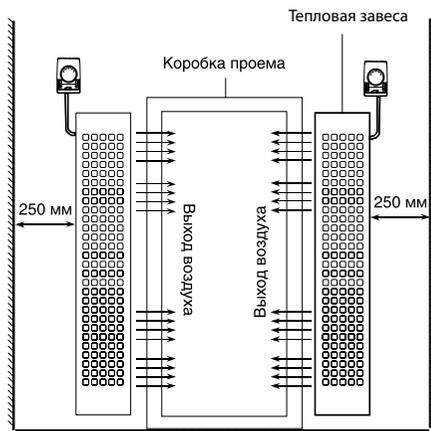
**Монтаж завесы на кронштейны.** Крепежные размеры для кронштейнов
