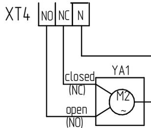
Подключение привода с возвратной пружиной или клапана
