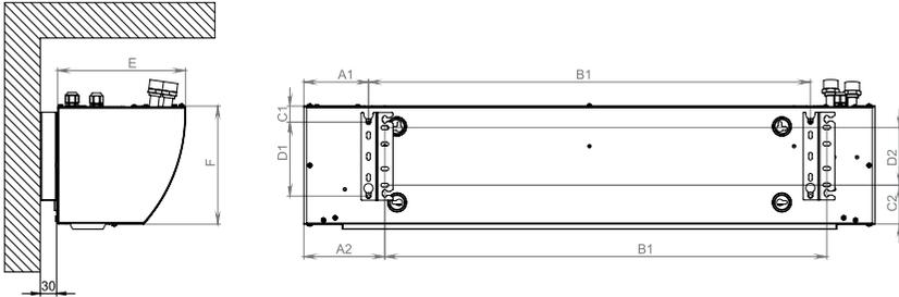
Расположение кронштейнов для установки завесы на шпильки
