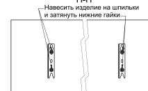
Навесить изделие на шпильки и затянуть нижние гайки
