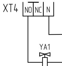
Пример подключения привода с возвратной пружиной/клапана и насоса
