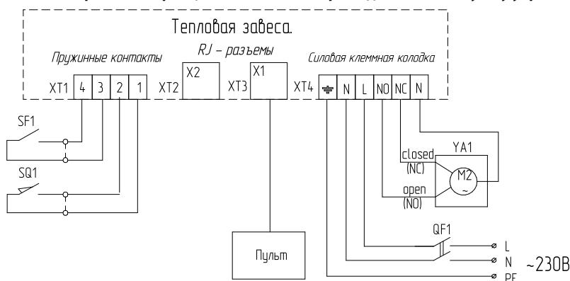
X3 - пружинная клеммная колодка кросс платы;
