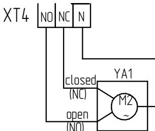
Подключение привода с возвратной пружиной или клапана
