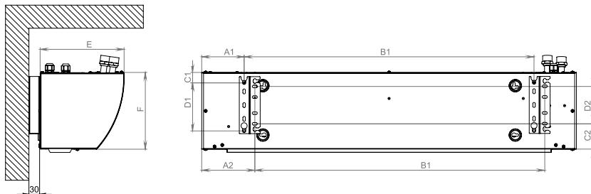
Расположение кронштейнов для установки занавесы на шпильки
