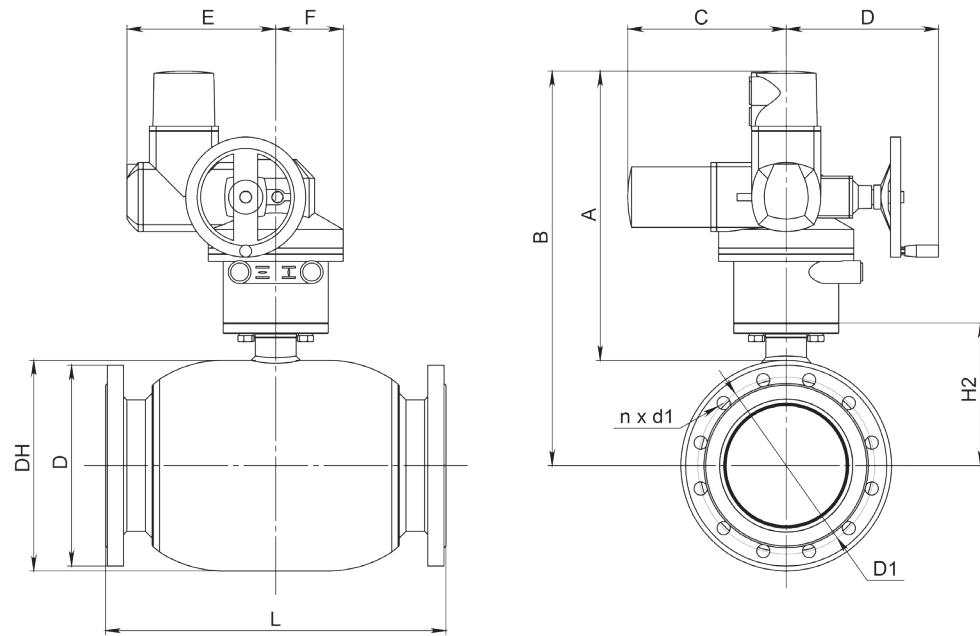
**Применение:** электроприводы применяются как исполнительный механизм для управления шаровыми кранами БРОЕН БАЛЛОМАКС®.
