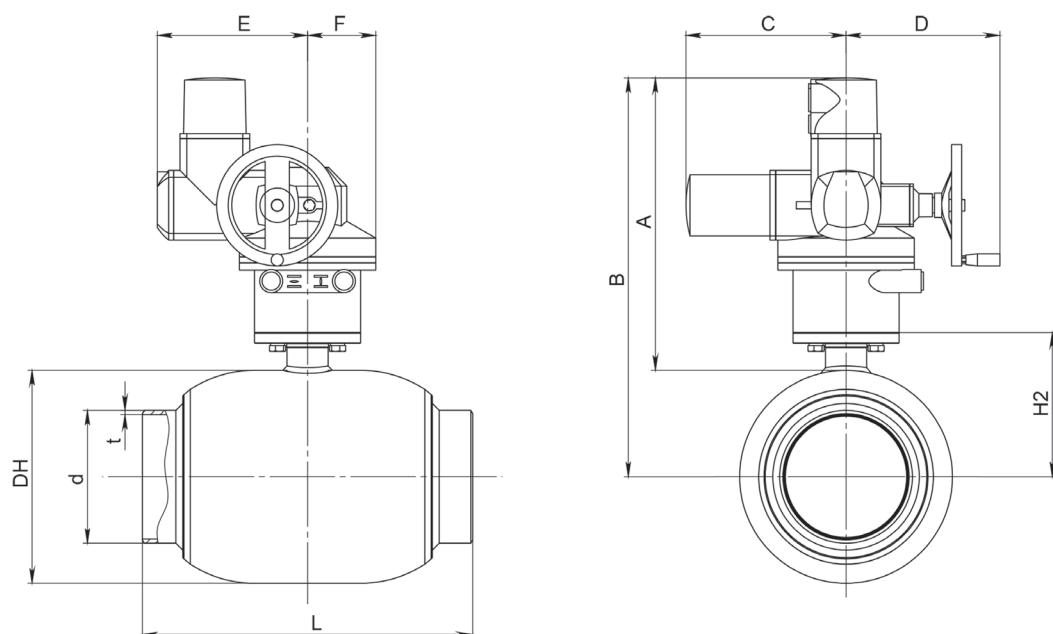
**Применение:** электроприводы применяются как исполнительный механизм для управления шаровыми кранами БРОЕН БАЛЛОМАКС®.
