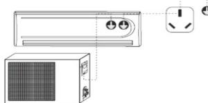
Кондиционер обязательно должен быть заземлен. Несоблюдение может стать причиной поражения электрическим током или других опасностей.
