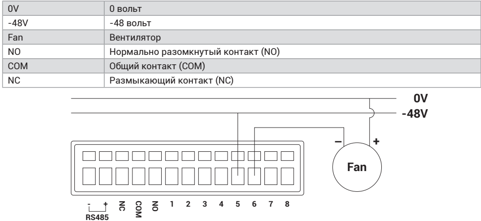
Рис. 2.3 Схема подключения интерфейса входа постоянного тока
