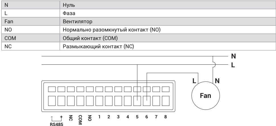
Рис. 2.2 Схема подключения интерфейса входа переменного тока
