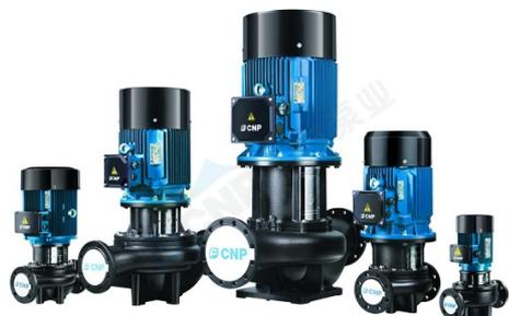
О продукте: одноступенчатый, центробежный, линейный насос; впускное и выпускное отверстия расположены горизонтально, выпускная сторона поднята над уровнем земли и могут быть отремонтирована без необходимости в демонтаже трубопроводов. Производительность и преимущества: Компактная структура, Удобное техническое обслуживание, Низкочастотный шум, Рабочее колесо доступно из чугуна и из нержавеющей стали.
