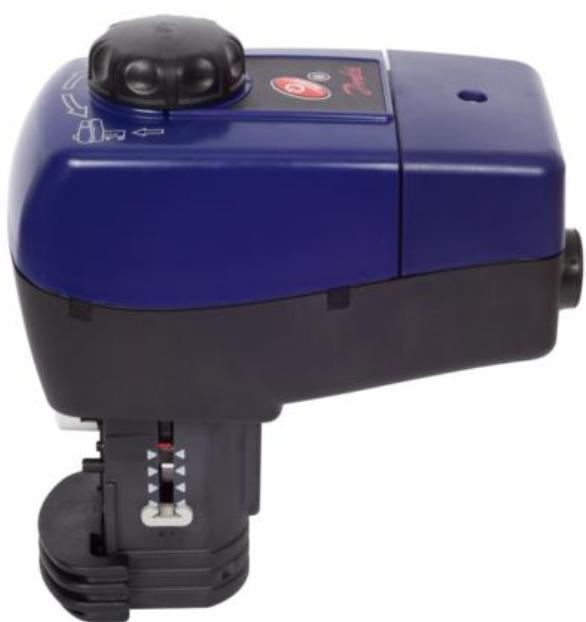
Приводы электрические типа АМЕ модификация 435 QM (далее – АМЕ 435 QM) предназначены для работы с клапанами балансировочными типа АВ-QM с условным проходом от 40 до 100 мм, управляющими подачей тепло- и холдоносителя в фэнкойлы или небольшие вентиляционные установки.
