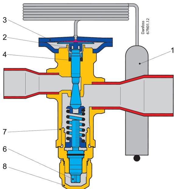
1. Термобаллон с капиллярной трубкой (нержавеющая сталь)
