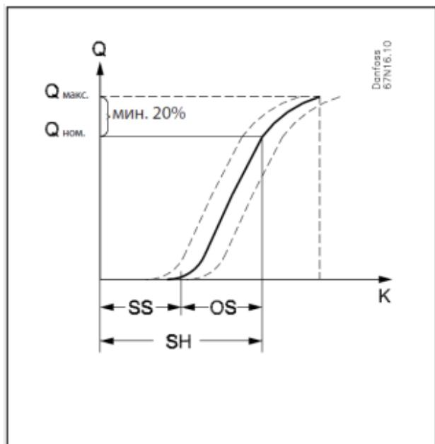
SS - статический перегрев (перегрев начала открытия клапана),
