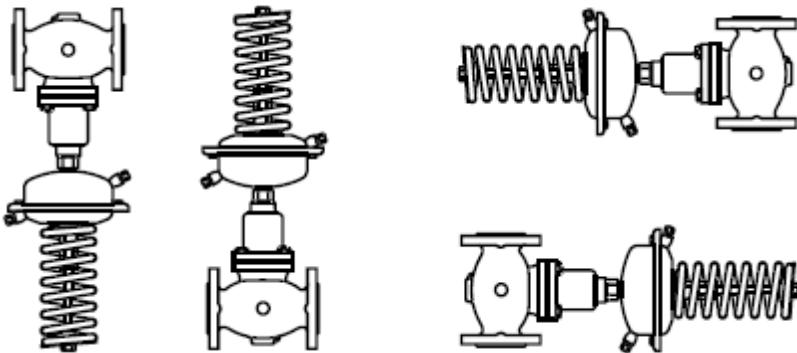
Клапаны регуляторы VFG2  $D_u = 100\text{--}250$  мм или клапанами регуляторы VFG2 любого диаметра при температуре перемещаемой среды выше  $120^\circ\text{C}$  должны быть установлены на горизонтальных трубопроводах регулирующим блоком вниз.
