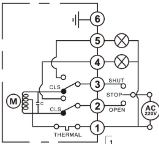
**5. СХЕМА ПОДКЛЮЧЕНИЯ 220В вариант 2 (два промежуточных позиционных переключателя с выводом сигнала, указывающего на полное закрытие или открытие крана)**
