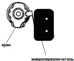
7.1. Вручную поверните кран в полностью открытое положение и проверьте, нажимает ли ограничитель хода на два микропереключателя в нижней части. Если нет, то ослабив фиксирующий винт ограничителя хода, переместите ограничитель в нужное положение. Аналогичным образом проверьте срабатывание ограничителя в полностью открытом положении крана.
