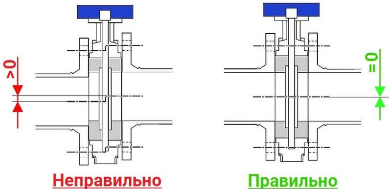
Рисунок 7 – Соосность ЗДПМ, фланцев и трубопровода
