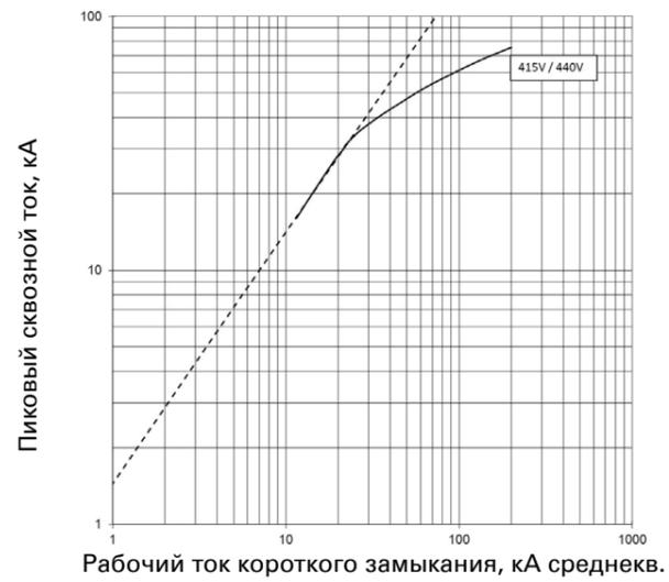
Сквозной ток  $I_D$ ; PDE3 ETU PXR10 LI;
