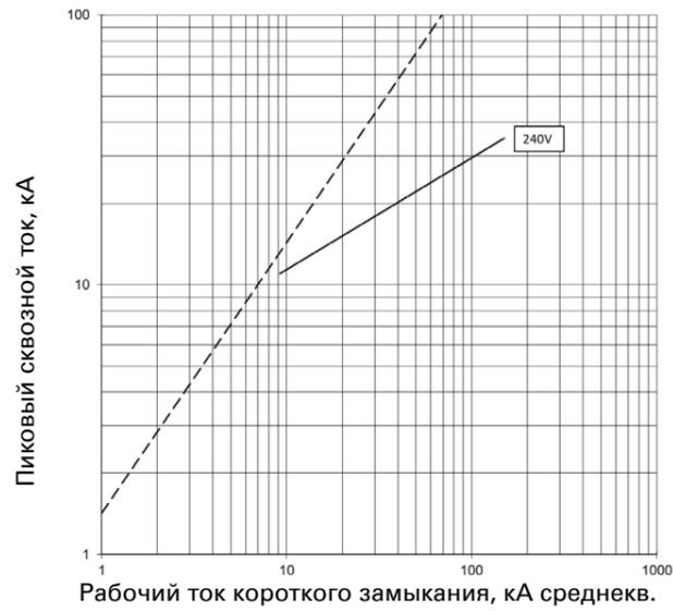
Сквозной ток  $I_D$  PDE2 ETU PXR10 LI;
