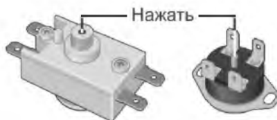
Рисунок 2. Возможные схемы расположения кнопки термовыключателя
