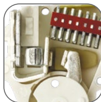
Серебросодержащая композитная напайка с вольфрамом
