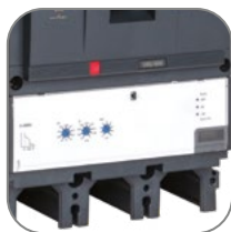
Микропроцессорный расцепитель Регулируемая уставка по тепловому току I_r = (0,4 - 1 I_n) и току перегрузки I_r = (2 - 10 I_n)
