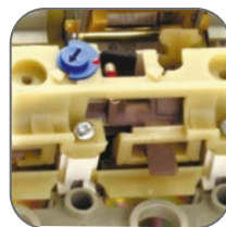
Регулируемый электромагнитный расцепитель Регулируемая уставка по тепловому току I_r = (0,8 - 1 I_n) и току перегрузки I_r = (5 - 10 I_n)
